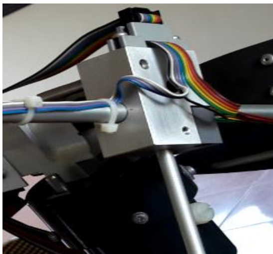
Hình 4.6: Vị trí cảm biến đo góc \alpha_v
